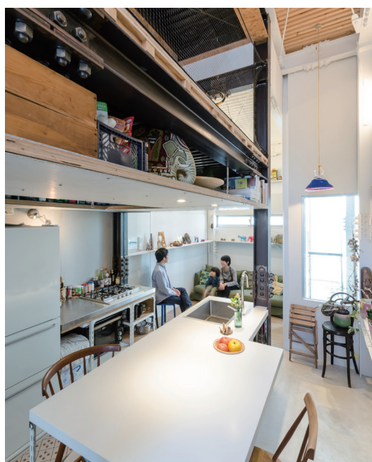
左上のロフト部分にモノを集めて下の空間をすっきりとさせている。天井の低いキッチンに対して右の吹き抜けの高さを3.9m、奥のリビングの高さを3.4mと余裕をもたせて空間に変化をつくり出している。
